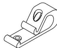
**Tendeur de chaîne** pour retenir la chaîne sur le bas du cadrage.
