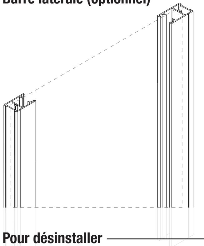
**8** Fixez les barres latérales à l'intérieur du cadre avec 2 vis minimum par barre.
